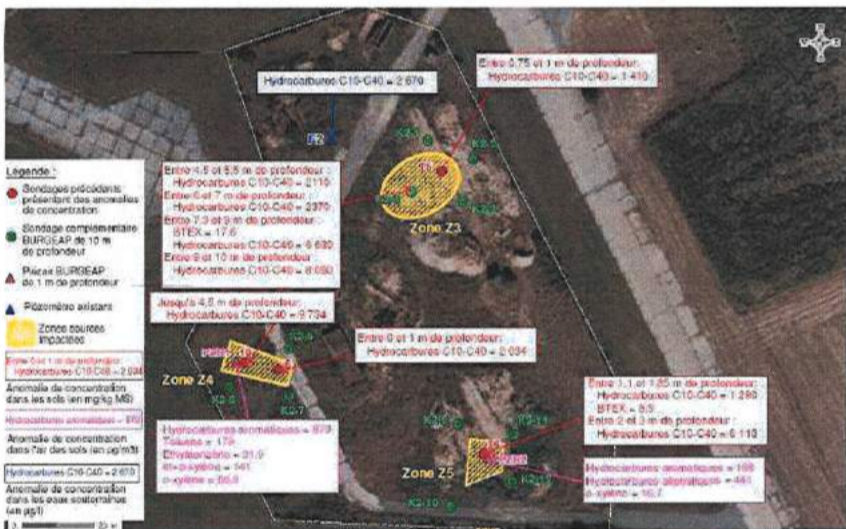
Figure 119 : Délimitation des sols impactés au droit du dépôt K2
