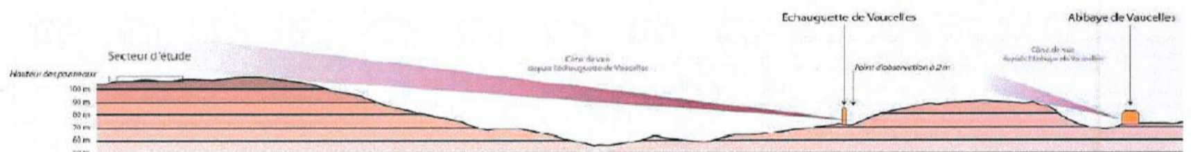
Figure 103 : Coupe topographique illustrant l'absence de risque de covisibilité entre avec le site de Vaucelle
