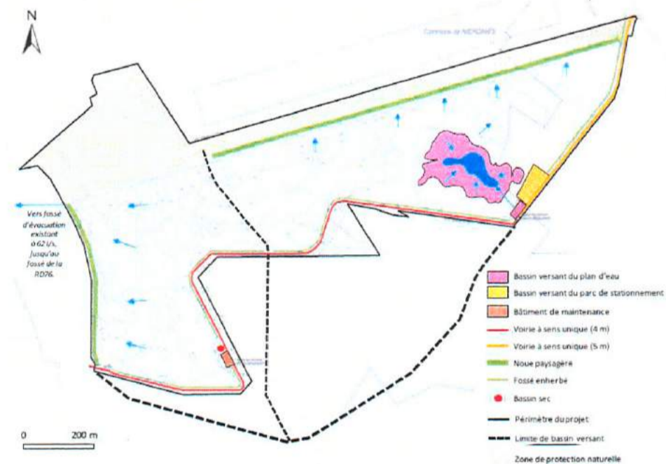
Figure 155 : Principes de gestion des eaux pluviales
